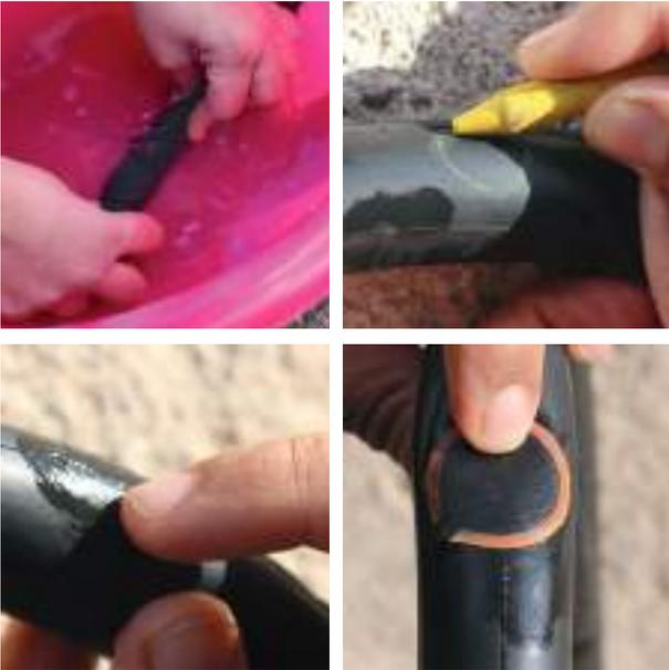
Inspectez l'intérieur du pneu à la recherche d'un objet tranchant, en prenant garde de ne pas vous blesser. Si vous ne voyez toujours rien, gonflez la chambre à air, plongez-la dans une bassine remplie d'eau et observez l'endroit où se forment de petites bulles d'air.
