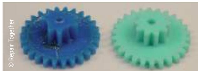
Réparation d'un engrenage de moteur de plateau de micro-ondes grâce à l'impression 3D.
