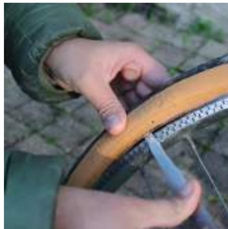
Faites levier avec l'un des démonte-pneus et sortez l'un des flancs de la chambre à air de son axe, en prenant bien soin de ne pas la pincer. Faites de même à 3 rayons d'intervalle avec un second démonte-pneu.
